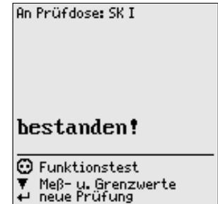
Zur Beurteilung der Meßergebnisse können Sie durch Drücken der Taste **▼** (8) alle Meßwerte und die entsprechenden gespeicherten Grenzwerte gemeinsam auf dem LCD-Anzeigefeld darstellen. *Bei den dabei angezeigten Meßwerten ist der Gebrauchsfehler des Prüfgerätes berücksichtigt.*
