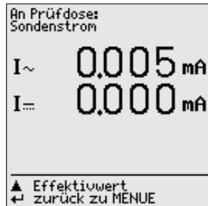
Bei einem Sondenstrom > 10 mA spricht eine elektronische Sicherung an. Eine Fehlermeldung (Fremdspannung an der Sonde, siehe Kap. 4.7) informiert Sie über diesen Zustand.
