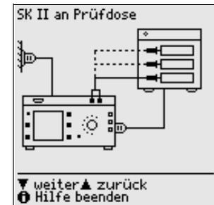
Geräte für ein- oder mehrphasigen Anschluß ohne Stecker (an Prüfbuchsen)
